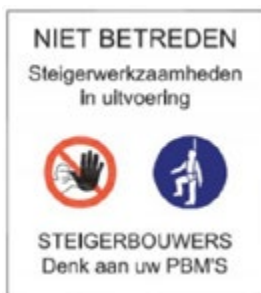
Steigerkaarthouder, zichtbaar tijdens steigerbouwwerkzaamheden
